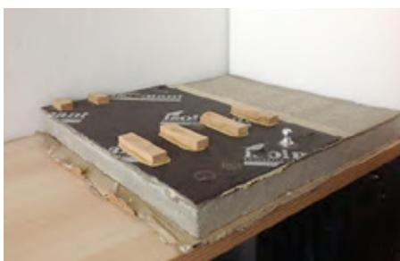
**B)** Provini per prove di shear su parquet incollato e provini per prove di strappo ("test dolly")
