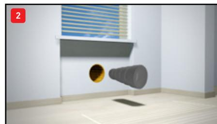
**2)** Posizionare Isolmant Tubo HP all'interno della sede creata. Qualora nel foro venga posizionato un tubo in PVC  $\varnothing$  16 cm, Isolmant Tubo HP verrà posato in esso, forzando l'inserimento senza danneggiare il silenziatore e rifilando l'eventuale eccedenza (dis. 2).
