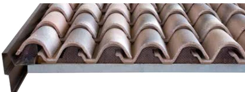
Esempio di preparazione falda con listellature e griglia parapasseri su linea di gronda e listello porta colmo fissato con gli appositi ganci.
