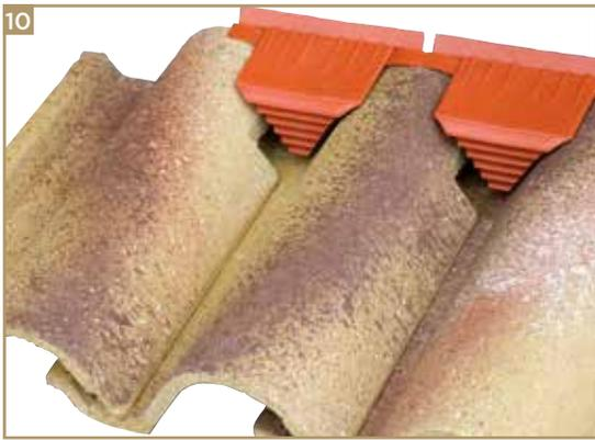
Quando si chiude la falda nella linea di colmo con una tegola intera oppure con una tegola accorciata meno di 50 mm, per ottenere una perfetta chiusura del tetto, si devono usare le apposite tegole sprovviste dell'incastro laterale (coppo imperiale® di colmo). La stessa cosa vale per la tegola terminale sx (coppo imperiale® terminale sx di colmo).
